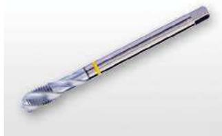
**Taraud machine SHARK bagué Jaune, goujure hélicoïdale à 40°, profil Métrique fin, norme DIN**
