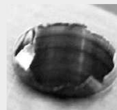
Bavure de sortie avec foret conventionnel
